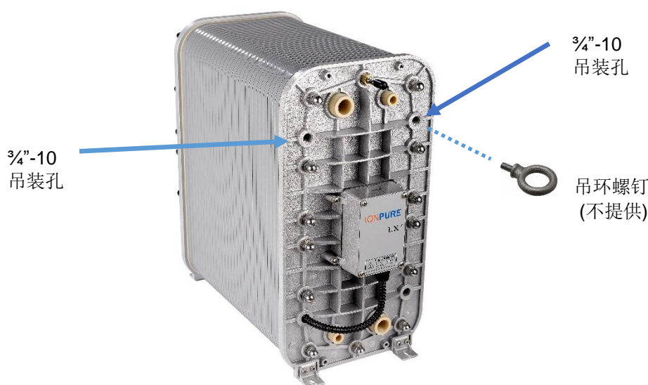
图 1-2 LX 膜堆起吊点 (阴极/管道接口端显示如下)
